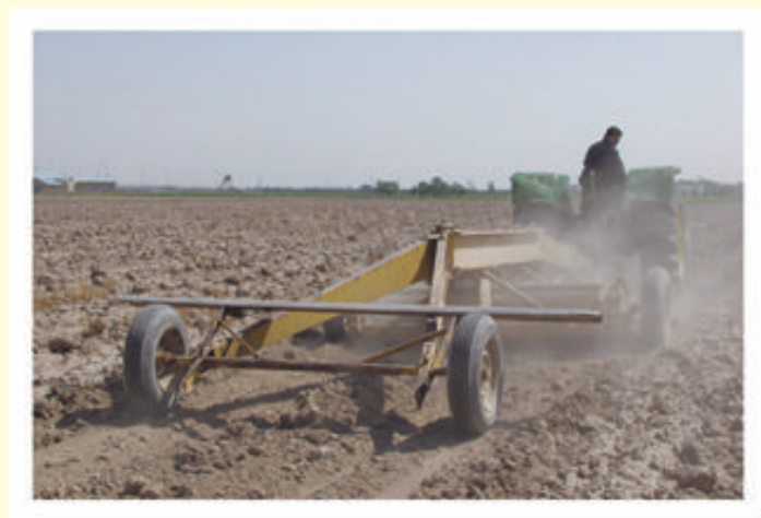
با توجه به اهمیت تسطیح زمین و تأثیر آن در سبزیکنواخت بوته ها و همچنین سهولت آبیاری، استفاده از لولر- بعد از دیسک زدن- ضروری است.
